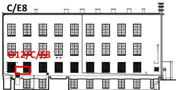
Rys. 14. Schemat rozmieszczenia odkrywek; elew. zach. skrzydła wschodniego.
